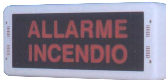
SF-LMA Lampada **monofaccia** ad **alta luminosità con segnalatore acustico**. Scritta **ALLARME INCENDIO**, posta su pannello in plexiglas **intercambiabile** di colore rosso. Installazione a parete, con le scritte ben visibili, indicanti le **vie di fuga**. Protetta contro l'inversione di polarità. Contenitore a forma di parallelepipedo da parete in ABS bianco. Alimentazione 12/24 V. Assorbimento 30 mA.
