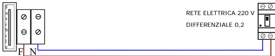
4) Collegamento della sirena radio SB-SAR: sirena autoalimentata con lampeggiatore, per trasmettere i comandi della centrale alla sirena è necessario il trasmettitore SB-TRA in dotazione alla sirena. Prima di fissare definitivamente qualsiasi componente che fa parte di un impianto radio, prova le
