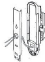
Portare i conduttori attraverso l'apposito foro e collegarli alle morsettiere (vedere Sez. 6). Assicurarsi di mettere i cavi tra le spugne della base e la piastra di fissaggio per evitare il passaggio di pioggia, polvere ed insetti.
