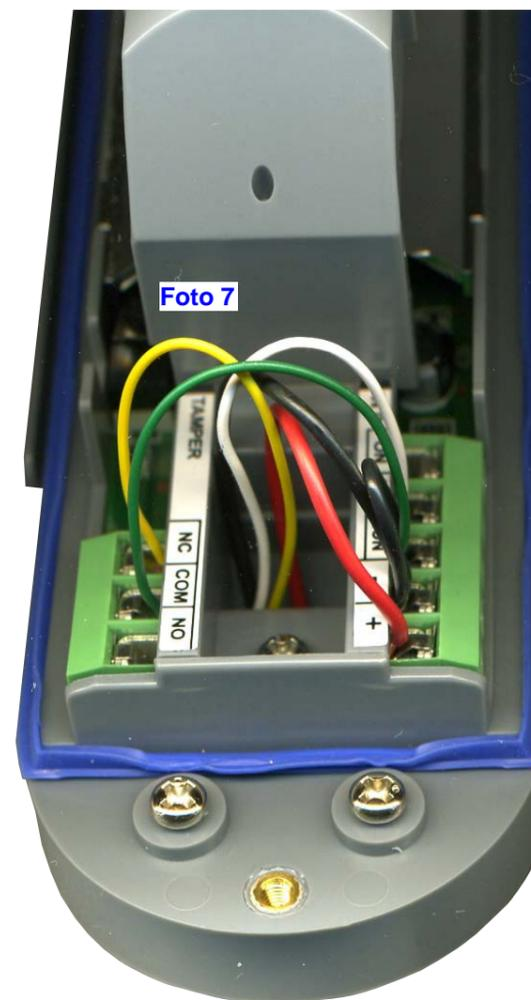
Alimentare con la batteria da 3,6 al litio in dotazione del sensore, attenersi alle regolazioni riportate nelle pagine precedenti, chiudere il sensore e fissarlo in modo stabile.
