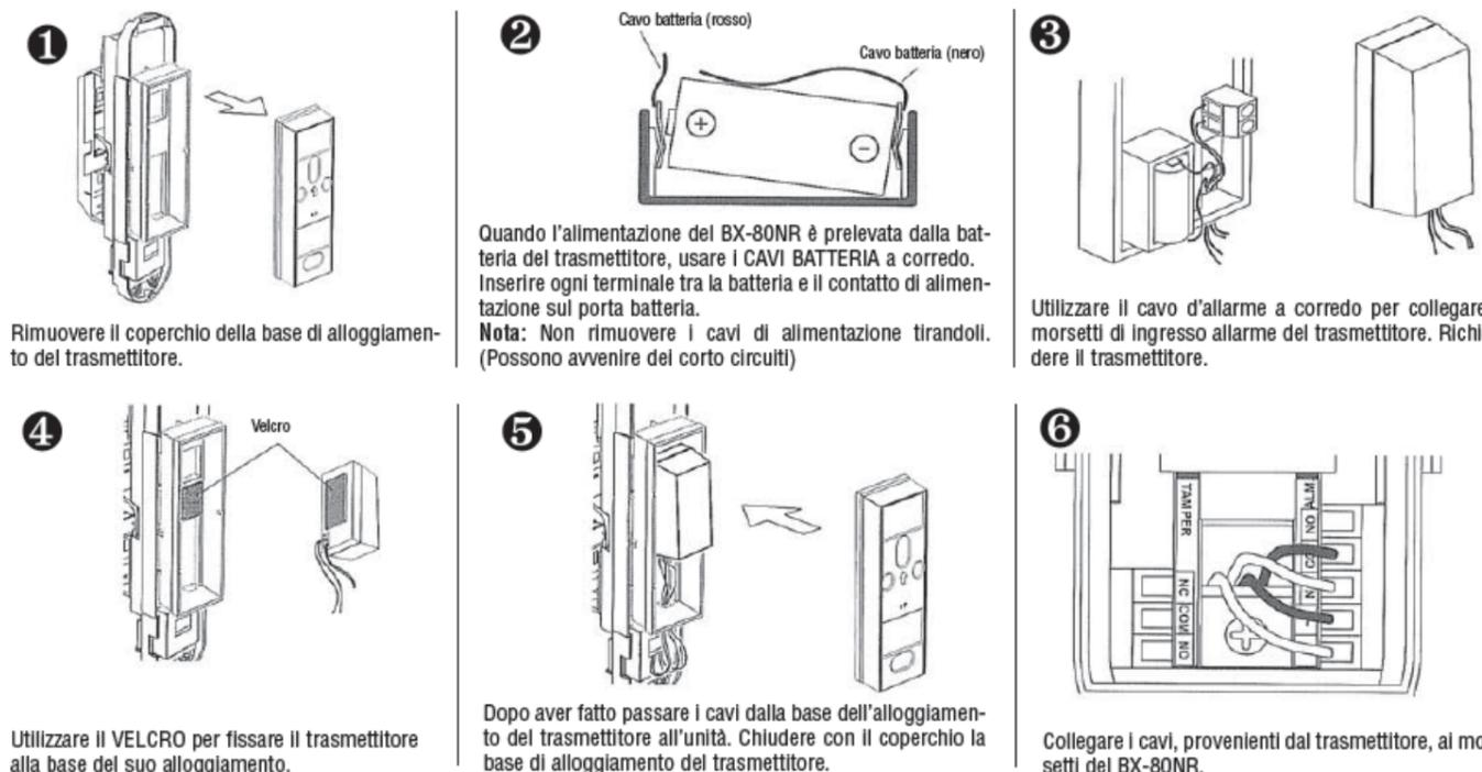
Utilizzare il VELCRO per fissare il trasmettitore alla base del suo alloggiamento.
