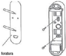
Usare la Dima di foratura. Dopo l'utilizzo della dima di foratura appoggiare sulla superficie il BX-80NR per il montaggio. Prendere come riferimento i segni dei fori eseguiti con la dima con l'eventuale tolleranza. Fissare quindi l'unità in posizione.
