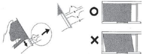
Rimuovere il supporto delle lenti dal coperchio come descritto nella Sezione 7-1. Far scorrere le lenti inferiori per regolare la portata di rilevazione. Scegliere la posizione appropriata dalla guida posta sul supporto delle lenti. (A, B, C, o D).
