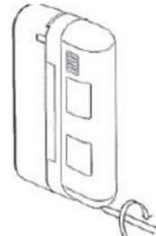
Montare il coperchio ed effettuare la prova movimento. Dopo aver completato la prova avvitare a fondo la vite del coperchio.
