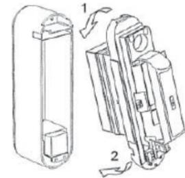
Dopo aver cablato il trasmettitore nell'unità occorre montarlo utilizzando le 2 viti. Innestare l'unità sulla base posteriore ed avvitare a fondo le 2 viti di blocco.
