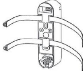
Utilizzare le fascette metalliche per fissare l'unità. Preparare le fascette sull'unità come disegno (Massima dimensione fascetta Larghezza mm 20 / Spessore mm 0,5)
