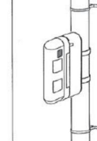
Montare l'unità, tramite le fascette metalliche, su un palo ben fissato
