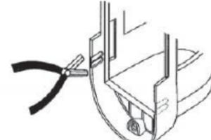
Togliere con delle pinze le paratie a sfondare per consentire il passaggio dei cavi esterni lateralmente all'apparecchio. Dopo il cablaggio, fissare l'unità alla piastra.
