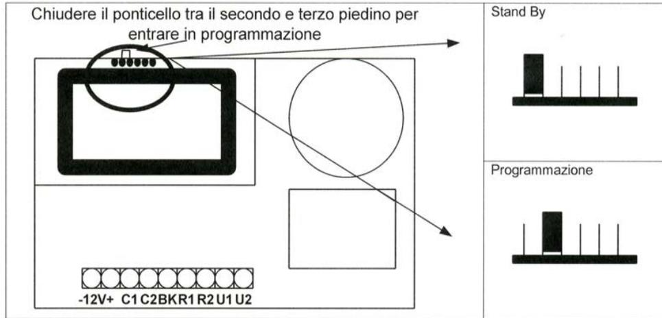
Una volta chiuso il ponticello il combinatore entrerà in modalità programmazione:
