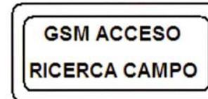
In questa fase il combinatore sta eseguendo la procedura di registrazione al ponte del gestore della rete GSM. Quando la procedura di registrazione va a buon fine viene segnalata tramite la riproduzione del messaggio vocale : "modulo registrato" e successivamente sul display viene indicato il livello del segnale tramite un indicatore che varia da 0 a 7 tacche.
